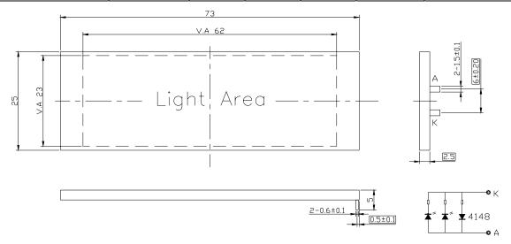
NOTE: 1.UNMARKED TOLERANCE IS ±0.30, 2.BACKLIGHT COLOR: WHITE, 3.THE MATERIAL IS LEAD-FREE.
