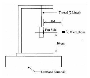
1 METER FROM MICROPHONE TO FAN INTAKE
