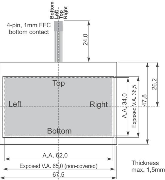
Potentiometer vergleichbar: Legt man an die Pins *Top-Bottom* eine Spannung von z.B. 3,3V, kann man am Pin *Left* oder *Right* eine Spannung welche linear zur Y-Richtung der Berührung ist messen. Den Berührungspunkt in X-Richtung erhält man über das Anlegen der Spannung an *Left-Right* und Messen an *Top* oder *Bottom*. Pinbelegung siehe Masszeichnung.
