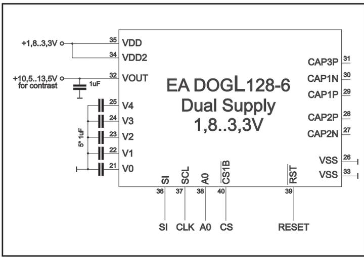
Stehen +10,5..+13,5V (unstabilisiert) für den Kontrast zur Verfügung, kann das Display ab 1,8V Logikspannung betrieben werden.
