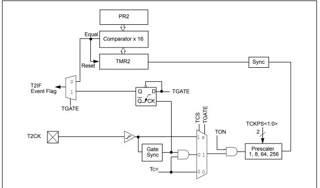
FIGURE 10-4: 16-BIT TIMER2 BLOCK DIAGRAM (TYPE B TIMER) FOR dsPIC30F6015
