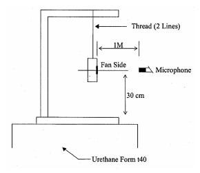
1 METER FROM MICROPHONE TO FAN INTAKE
