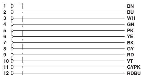
Przyporządkowanie styków gniazda M12
