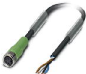
Kabel czujnika/urządzenia wykonawczego, 4-pinowa, PUR, czarny RAL 9005, wolny koniec przewodu, na Gniazdo proste M8, Długość kabla: 2 m
