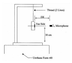
1 METER FROM MICROPHONE TO FAN INTAKE
