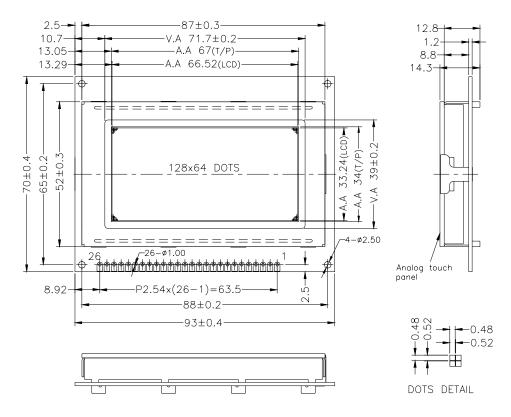
REMARKS: 1,UNMARKED TOLERANCE IS ±0.3 2,THE MATERIAL COMPLY WITH RoHS
