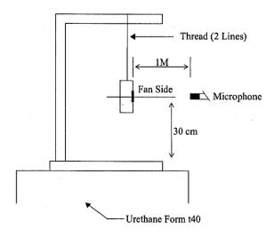
1 METER FROM MICROPHONE TO FAN INTAKE
