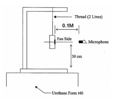
0.1 METER FROM MICROPHONE TO FAN INTAKE
